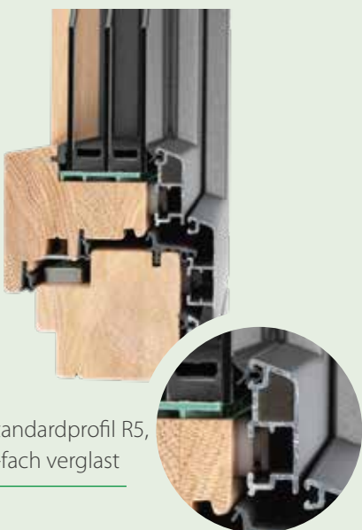
Konturprofil flächenbündig, 3-fach verglast
